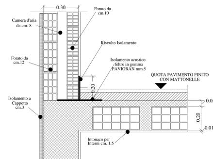
PARTICOLARE ASSONOMETRIA ISOLAMENTO DEI SOLAI rapp. 1:10
