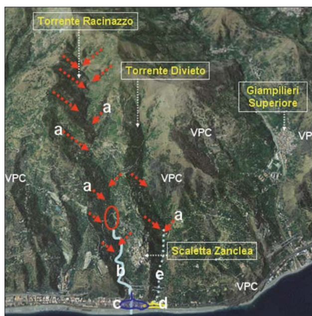
Figura 1 – Area "epicentrale" degli effetti al suolo causati dall'evento piovoso del 1° ottobre 2009. Nessun pluviografo ufficiale era installato nell'area (l'associazione meteoweb riporta 300mm di pioggia in 3 ore mentre le fonti ufficiali del SIAS 170 mm di pioggia in 3 ore).
