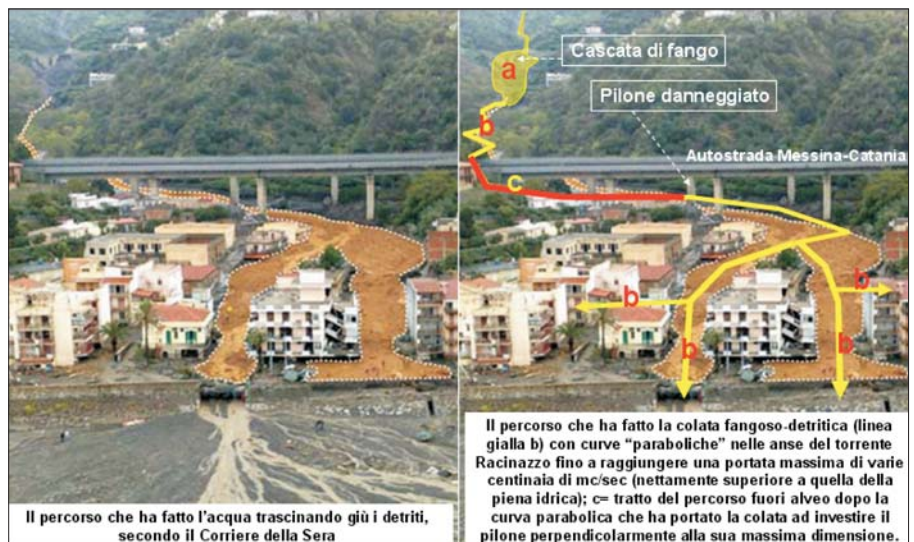
Figura 18 – A sinistra è riportata la ricostruzione dell'evento pubblicata dal "Corriere della Sera on line" che attribuisce erroneamente l'evento a una piena idrica che ha trascinato i detriti. Sulla stessa foto, a destra, è riportata la ricostruzione del fenomeno rappresentato da una rapida e potente colata fangoso-detritica.
