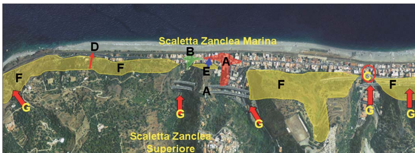
Figura 27 – Rappresentazione schematica degli effetti geoambientali principali causati dagli eventi alluvionali del 2007 (E) e del 1° ottobre 2009 (A, B, C, D): A= area devastata dalla colata fangoso-detritica del Torrente Racinazzo; B= area interessata dall'accumulo di detriti trasportati dal Torrente Divieto; C= alveo del Torrente Itala colmato di detriti; D= colata di fango che ha interessato la strada statale e la linea ferroviaria travolgendo un furgone; E= colata di fango che ha invaso la strada statale nell'ottobre 2007. Individuazione schematica dei principali pericoli geoambientali che possono interessare Scaletta Zanclea Marina in concomitanza con eventi piovosi molto consistenti come verificatosi tra settembre e il 1° ottobre 2009: F= area d'innescio ed evoluzione di colate di fango lungo i ripidi versanti; G= colate fangoso-detritiche incanalate.
