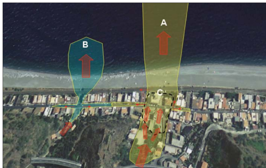
Figura 23 – Principali effetti causati dall'evento del 1° ottobre 2009 tra il Torrente Racinazzo (in giallo trasparente) e il Torrente Divieto (in verde trasparente). A= Area interessata dal transito e deposito di detriti della colata fangoso-detritica; B= area interessata dall'accumulo di detriti da parte del Torrente Divieto.
