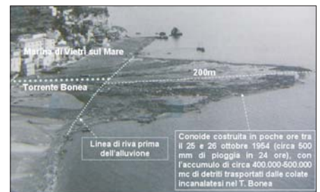
Figura 19 – Modificazione della morfologia costiera della spiaggia di Marina di Vietri sul Mare dopo l'evento alluvionale del 25 ottobre 1954. Una parte dei detriti si sedimentò nei fondali del Golfo di Salerno.
