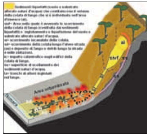
Figura 2: Schema della morfologia e stratigrafia dell'area di Giampileri Superiore (versante e area pedemontana) e zonazione tipica di un'area di versante e dell'area urbanizzata che è stata interessata dalle colate rapide di fango.
