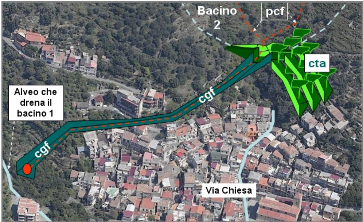
Figura 69: **Cgf**= canale di gronda per la raccolta, incanalamento e smaltimento delle colate rapide di fango che possono svilupparsi nei bacini 1,2,3,4,5 e 6; i canali sono delimitati da paratie di pali tirantati. **Pcf**= percorso di eventuali colate rapide di fango. **Cta**= parti di versante comprese tra i bacini imbriferi da consolidare mediante consolidamento di terrazzi agricoli
