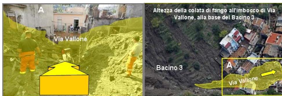
Figura 18: La foto a sinistra illustra la parte inferiore del bacino 3 all'imbocco di Via Vallone. In giallo trasparente è ricostruita una colata rapida di fango simile a quella che ha investito le costruzioni con un impatto devastante. Il riquadro A, delimitato dalla linea gialla nella figura a destra, illustra l'area evidenziata nella figura in alto, dove massima è stata la distruzione. In giallo trasparente è ricostruita la morfologia della colata nella zona d'impatto con le costruzioni.
