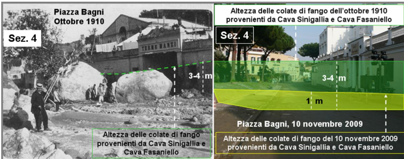
Figura 60: Ricostruzione della morfologia (in giallo trasparente) dei flussi fangosi del 10 novembre 2009 in Piazza Bagni (sezione 4 a destra). In verde è rappresentata la morfologia dei flussi fangoso-detritici verificatisi nell'ottobre 1910 che devastarono le stesse aree interessate dall'evento del 10 novembre 2009.
