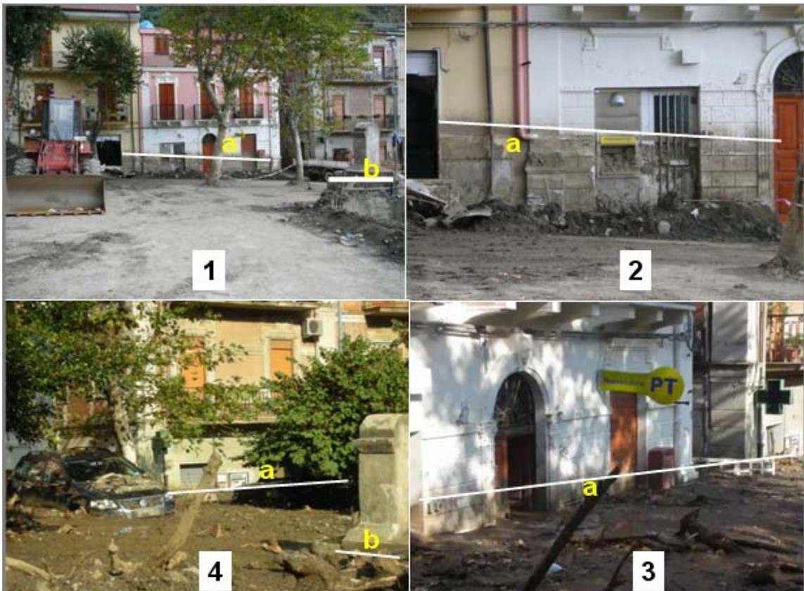
Figura 20: Le foto 1 e 2 illustrano la Piazza del Pozzo, vicino al T. Giampileri, dopo l'asportazione del fango e detriti che raggiungevano l'altezza evidenziata dalla linea bianca a e b. Le foto 3 e 4 evidenziano l'altezza del fango accumulato nella Piazza del Pozzo, indicata dalle linee bianche a e b.
