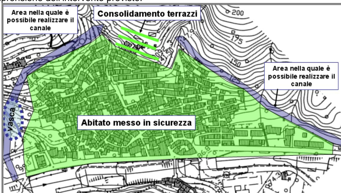
Figura 67: Schema della proposta di messa in sicurezza di Giampilieri Superiore. L'abitato verrebbe messo in sicurezza mediante la realizzazione di un canale occidentale che
