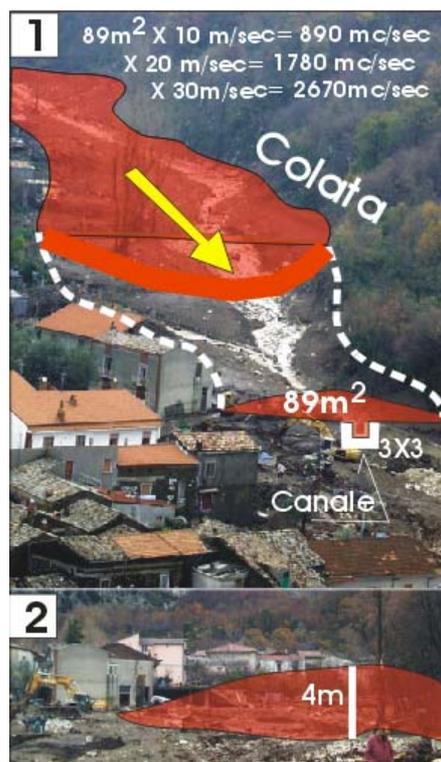
Figura 57: Ricostruzione della morfologia del flusso fangoso-detritico che ha investito la parte settentrionale dell'abitato di Ioffredo in base alle tracce lasciate. La parte frontale del flusso aveva un'altezza di circa 4 m e una portata massima di circa 890 mc/sec (assumendo una velocità di scorrimento di 10 m/sec). E' evidente l'esiguità della sezione del canale esistente progettato per lo smaltimento delle piene conseguenti agli eventi piovosi dell'esiguo bacino imbrifero.
