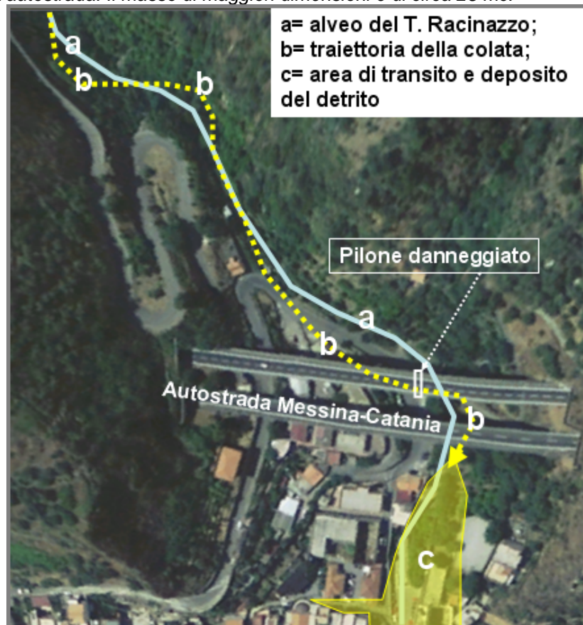
Figura 11: Ricostruzione del tracciato, in base all'impronta lasciata lungo i versanti, del flusso fangoso-detritico nella parte terminale dell'alveo del T. Racinazzo (a). Sono evidenti le esondazioni del flusso (b) in corrispondenza delle anse del torrente che hanno provocato l'impatto del fronte della colata perpendicolarmente alla massima dimensione del pilone dell'Autostrada Messina-Catania. In giallo trasparente (c) è evidenziata l'area interessata dal transito e accumulo del detrito.
