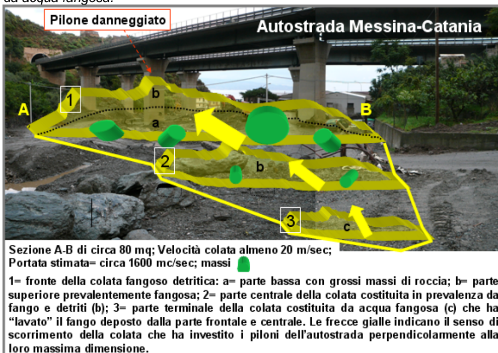
Figura 7: Ricostruzione schematica della morfologia della colata fangoso-detritica nella zona d'impatto con i piloni dell'Autostrada Messina-Catania.
