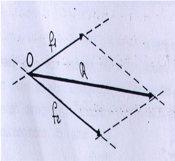
La risultante  $R$  sarà data dalla diagonale del parallelogramma, così ottenuta (fig.3). Il verso lo possiamo ottenere immaginando di spostare  $f_1$ , mettendolo di seguito ad  $f_2$ , ovvero sarà dato dal verso dei due vettori posizionati in successione. Lo stesso discorso lo possiamo fare con  $f_2$ .
