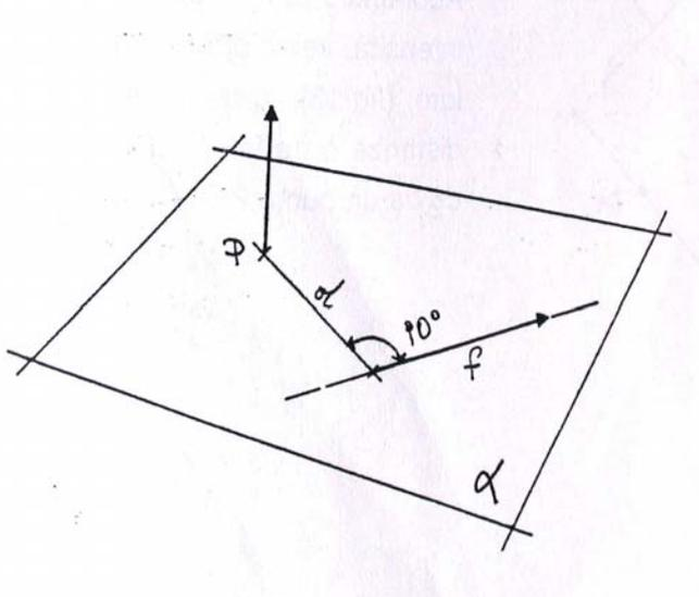
Graficamente il momento di un vettore rispetto ad un polo  $P$  è rappresentato da un vettore perpendicolare al piano  $\alpha$ , e che esce verso l'alto o verso il basso. Se il verso di rotazione è antiorario, il vettore momento esce verso l'alto, viceversa, se il verso del momento è orario, il vettore momento esce verso il basso.
