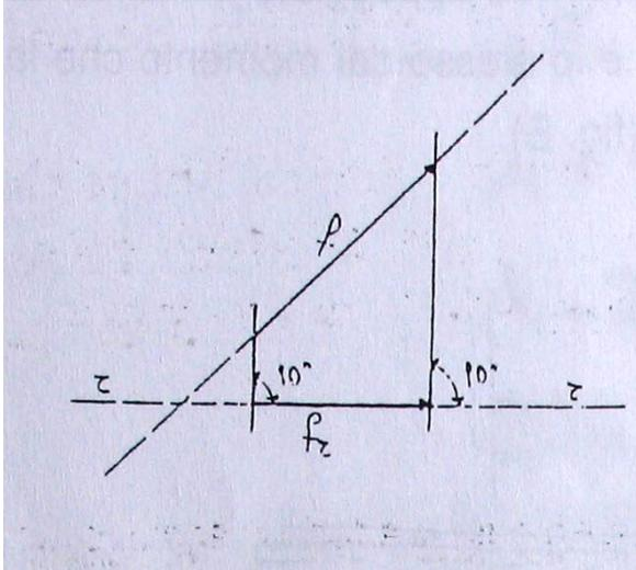
Se abbiamo un vettore  $f$  ed una retta  $r$ , proiettando  $f$  su  $r$  abbiamo la componente  $f_r$  di  $f$  sulla retta  $r$  (fig.1b). Analogamente possiamo effettuare la stessa procedura lungo i tre assi cartesiani  $x, y, z$  ed avere quindi le componenti  $f_x, f_y, f_z$ .
