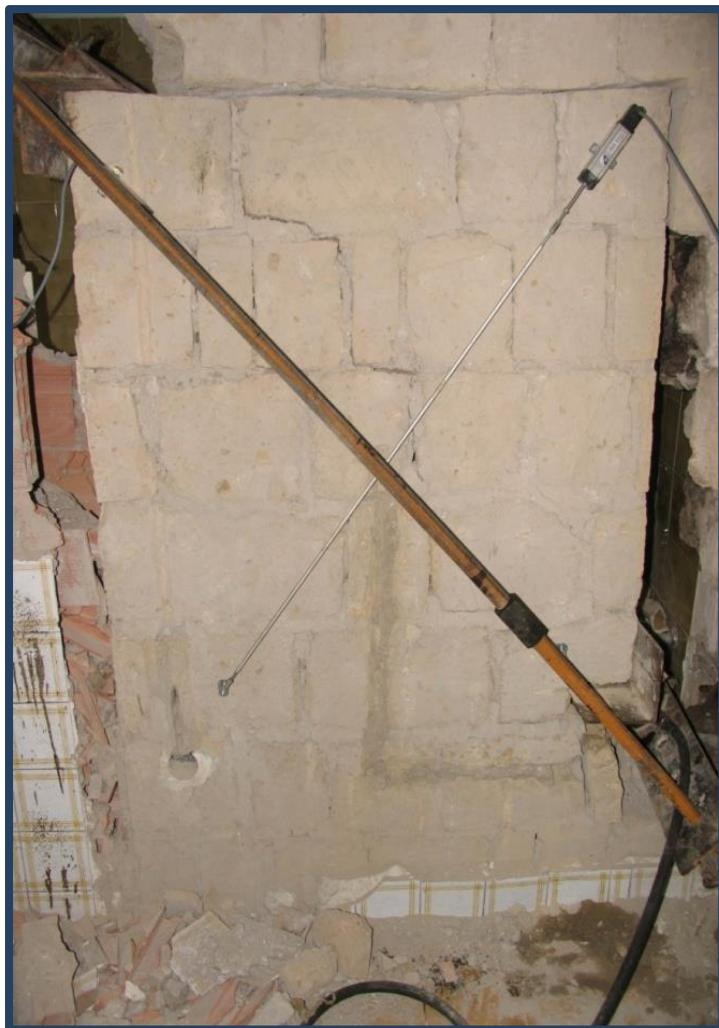
**Applicazione del carico fino alla rottura del pannello
